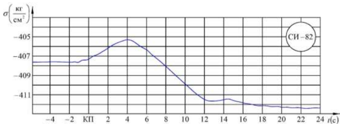
Рис. 4. График механических напряжений в арматуре фундаментной плиты при динамическом нагружении СС в условиях безоблачности, СИ-82 11.08.1983
