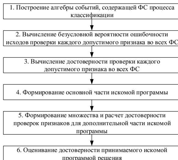
Рис. 1. Схема построения условной, оптимальной по достоверности принимаемого решения программы G классификации типа ТМП
