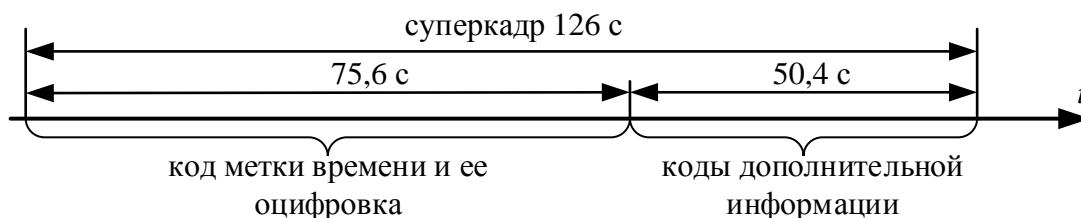
Рис. 3. Структура предлагаемого суперкадра для РСДН-20
