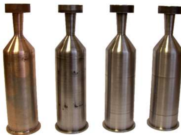
Рис. 3. Набор огневых стенок модельной камеры сгорания
