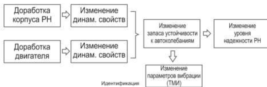
Рис. 2. Схема контроля динамических характеристик корпуса РН
