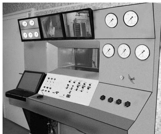
Рис. 7. Огневой бокс и пульт управления
