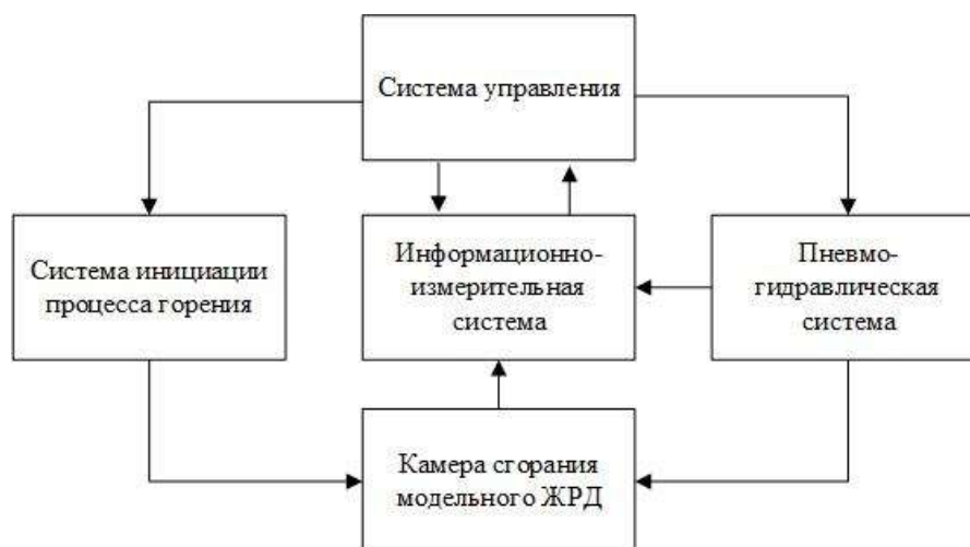
Рис. 1 Структурно-логическая схема взаимодействия систем стенда огневых испытаний модельных ЖРД
